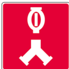
Raccords-pompiers pour le réseau de gicleurs
